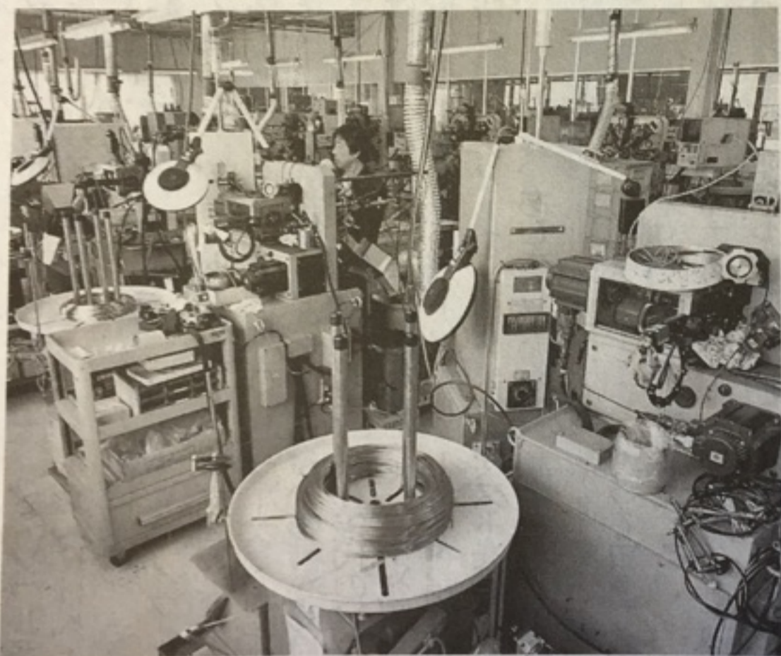
ばねを製造する成形機が並ぶ工場内
